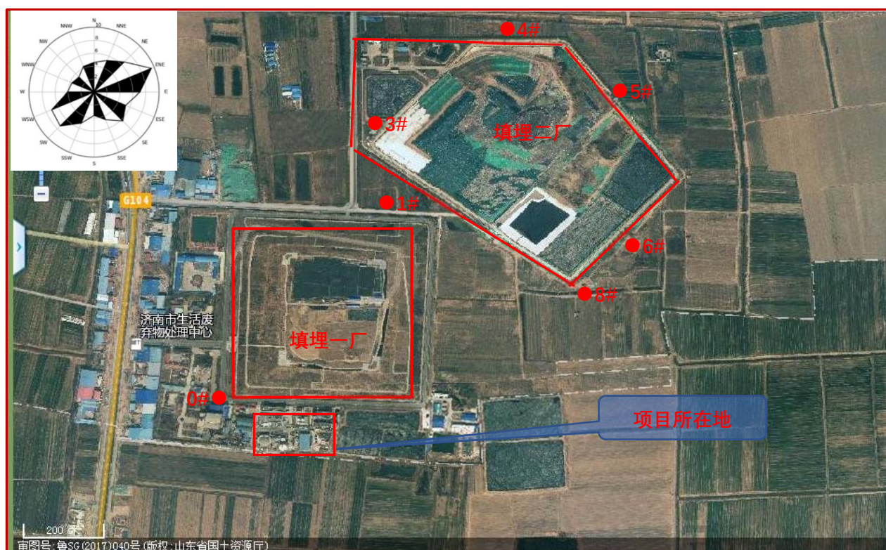
图 4.4-3 (2) 济南市生活垃圾填埋场地下水监控井示意图
